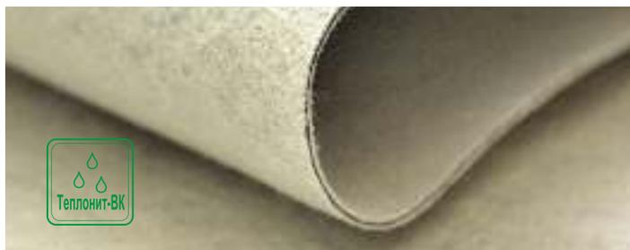
**Полотно гидроизоляционное Теплонит-ВК, ТУ 8397-006-2150-6643-2015** - противофильтрационный материал, состоящий из слоев геотекстиля и полиэтиленовой пленки (геомембраны). Слои скреплены между собой по запатентованной технологии АО «Втор-Ком».
